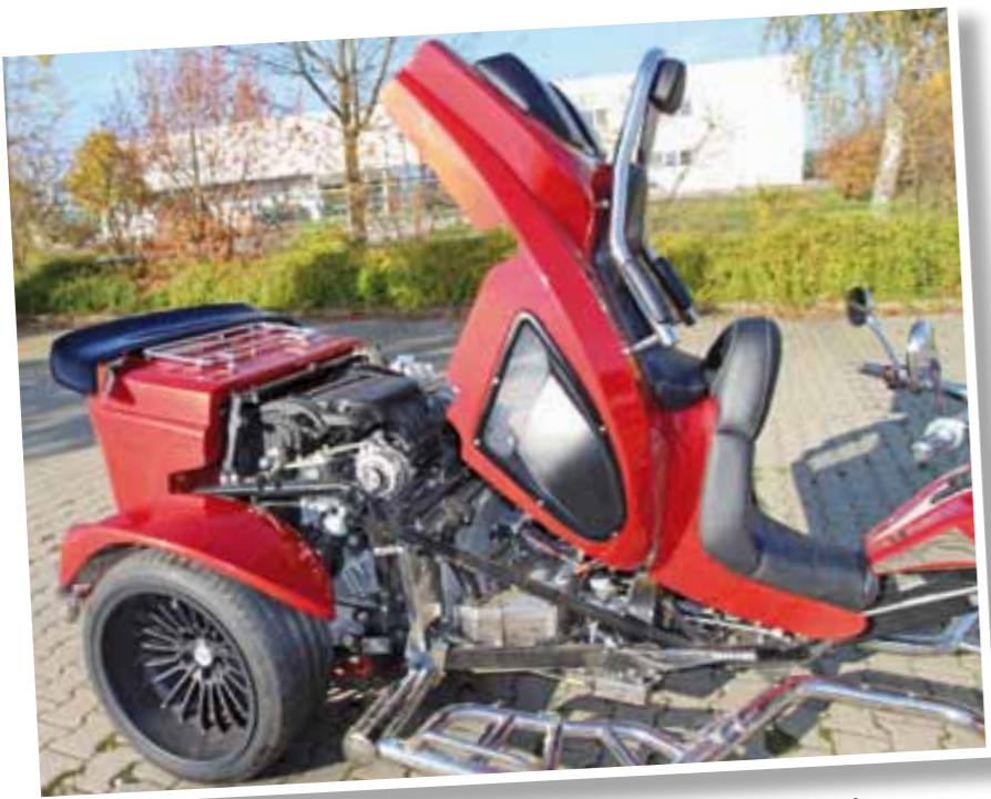
Die Hubmatik ist mechanisch eine geschickte Einrichtung. Das Fahrzeug ist von zwei Seiten für Wartungsarbeiten problemlos zugänglich.
