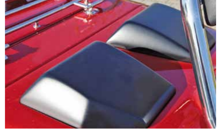
Die beiden Lufthutzen oben aus der Karosse, ziehen die warme Luft von Kühler und Motor aus der gedeckelten Karosserie. Sie sorgen so für eine Luftzirkulation.
