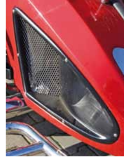
Dieser Lufteinlass und sein Zwilling auf der anderen Seite, dienen zu Belüftung von Kühler und dem Motorraum.
